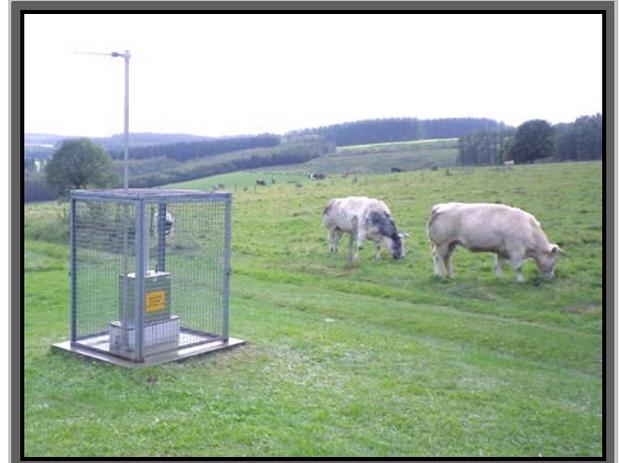
Figure 18 : Station de mesure des rayonnements gamma ambiants
