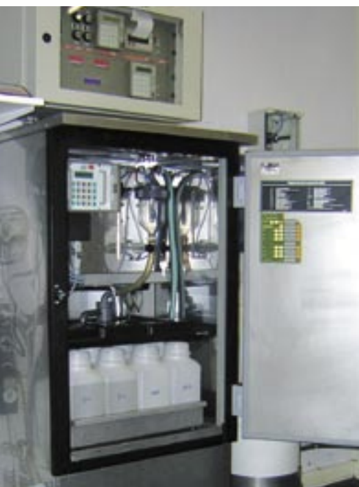
Figure 7 Échantillonneur automatique d'eau de rivière (présent dans toutes les balises rivières TELERAD).
