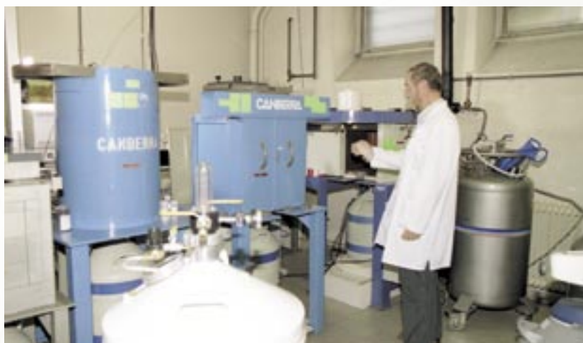
Figure 8 Chaîne de comptage gamma (spectromètre de haute résolution au germanium).
