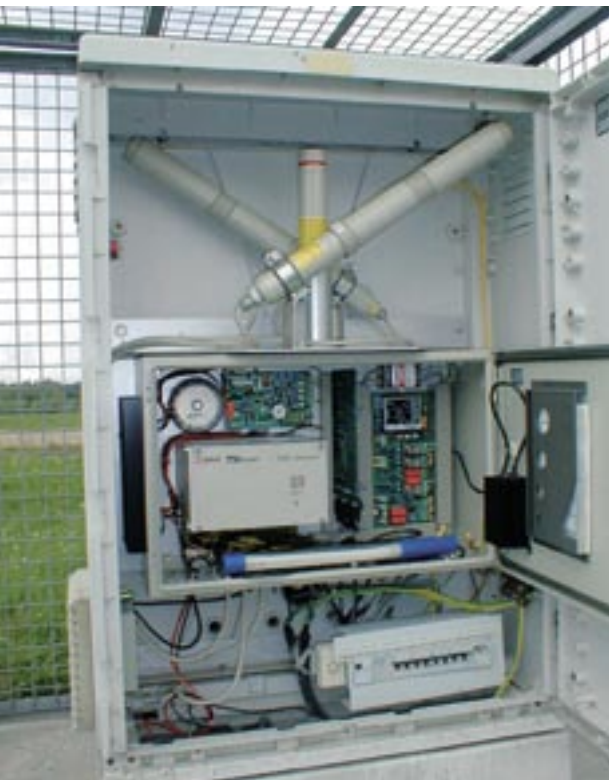
Figure 3 Balise atmosphérique de dosimétrie ambiante ouverte avec ses trois détecteurs.
