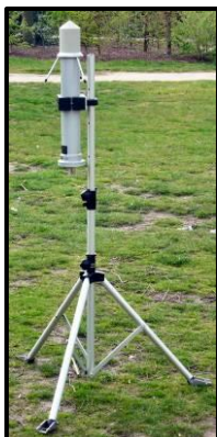
Figuur 7. Illustratie van een mobiel meetstation om de gammaradioactiviteit in de omgeving te meten.
