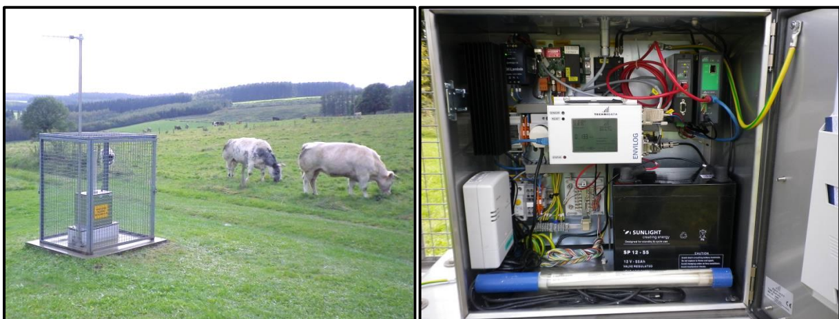
Figuur 3. Illustratie van een spectrometrisch meetstation dat de gammaradioactiviteit in de omgeving meet, evenals 10 vooraf gedefinieerde radionucliden.
