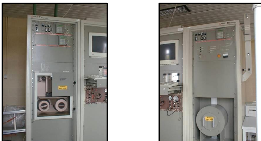
Figuur 4. (Links) Illustratie van een alfa/bèta-meeteenheid met zicht op de neerklapbare filterband die stof en deeltjes uit de lucht verzameld. (Rechts) De radioactief jodiumdetector in de afscherming (cilinder) en de parallellepipedumbuis met de actieve koolpatronen (aan de rechterkant).
