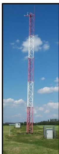
Figuur 8. Illustratie van een station gemonteerd op een mast van 30 m hoog rond de Belgische nucleaire sites (MET 30 station) dat windsnelheid en windrichting, regenval en uren zonneshijn meet.
