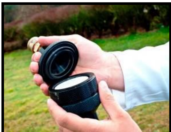
Figuur 19: opmeting van een atmosferische filter door het FANC
