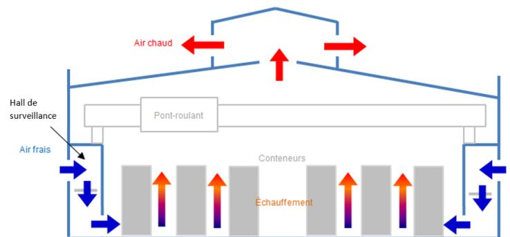
La conception thermique de l'installation tient compte de températures extrêmes constantes, et des effets du réchauffement climatique. Le bâtiment SFB est équipé d'un pont-roulant dit « à critère de défaillance unique » afin de limiter les risques de chute d'un emballage durant sa manutention.
